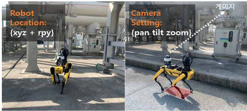
그림 2. 신중부변전소 내 시설점검 무인순찰 기술 (대학 사전 수행 프로젝트)
